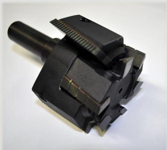
Composé d'un décheteur Z=3 axial avec brise-copeau et d'une fraise Z= 3+3 axial avec fixation cylindrique D. 20mm.
