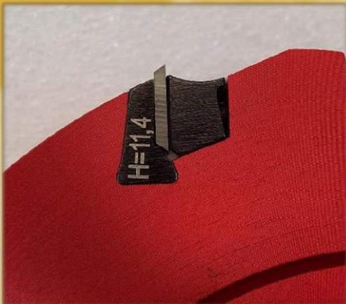
Détail d'un emplacement d'un porte-outils avec plaquette
